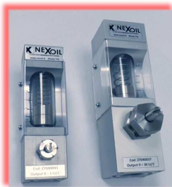
I flussostati e i flussometri, genericamente chiamati indicatori di flusso, vengono utilizzati per regolare, misurare e controllare visivamente ed elettricamente, la portata di liquido sotto pressione (max 15 bar).
